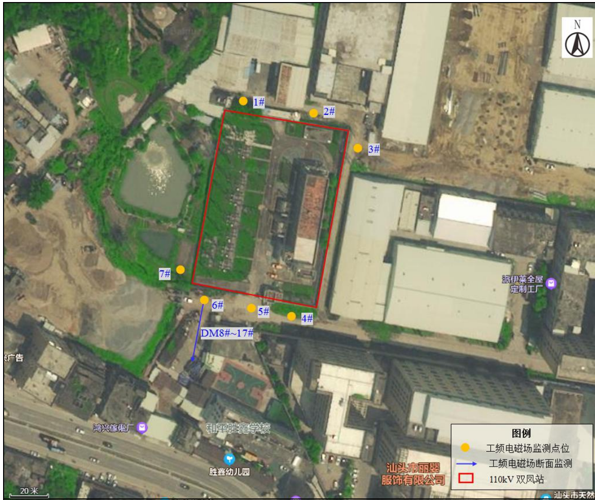
图 8.1-3 汕头 110kV 双凤变电站监测布点图
